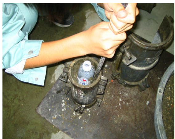
突き固めの様子
