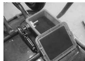
写真8 電気系統の収納箱及びモーター
