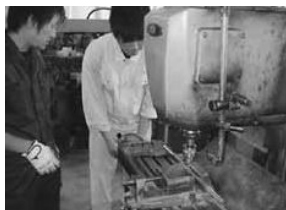
写真4 フライス盤作業
